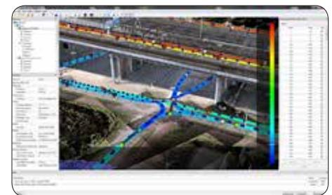
真彩色三维激光点云同步显示高清全景影像
