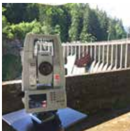
1套拓普康 Delta 系统 +MS05AXII 监测机器人可 完成 混凝土大坝监测
