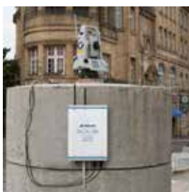
1套拓普康 Delta 系统 +MS05AXII 监测机器人可 完成 路面沉降监测
