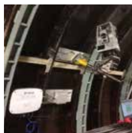
10套拓普康 Delta 系统 +MS05AXII 监测机器人进 行 地下工程监测
